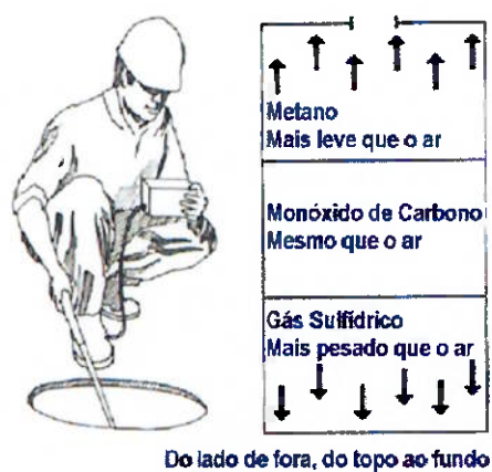
Figura 4 - detecção de Gases em espaços confinados
